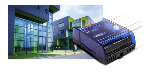
Módulo de 8 salidas triac controlado por microprocesador. Las salidas son configurables como todo/ nada o modulantes PWM. Equipado con comunicación serie Modbus RTU (RS485). El mapa modbus nativo garantiza una integración perfecta en una gran variedad de sistemas PLC y SCADA.
