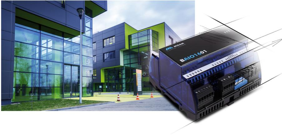
Módulo mixto controlado por microprocesador con una combinación de 16 entradas y salidas, 8 entradas analógicas configurables (voltaje, resistencia, temperatura e intensidad) y 8 salidas analógicas señal 0...10 V CC. Equipado con comunicación serie Modbus RTU (RS485). El mapa modbus nativo garantiza una integración perfecta en una gran variedad de sistemas PLC y SCADA.
